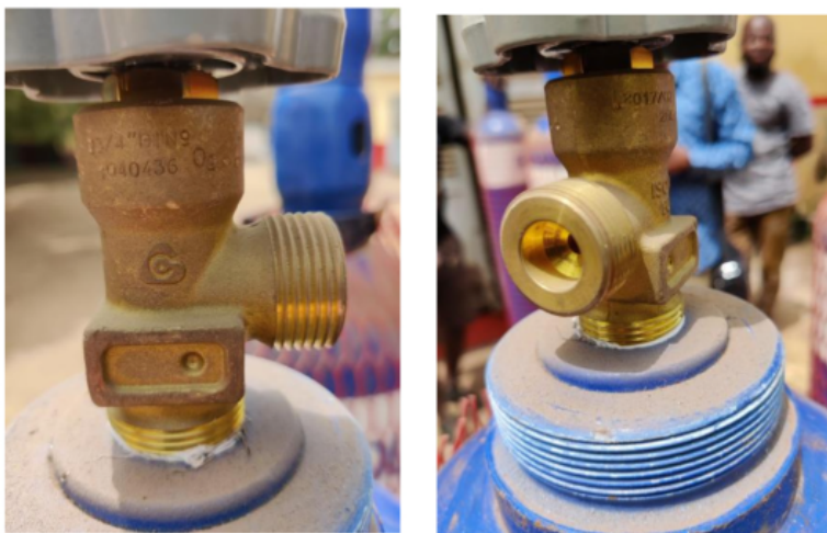
Figures 9 et 10 : Exemples de Vannes de normes allemandes avec inscrits d'identification
