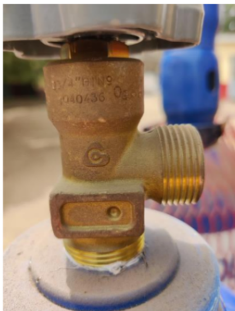
Figures 3 et 4 : Exemples de Vannes de Norme allemandes avec les inscrits d'identification
