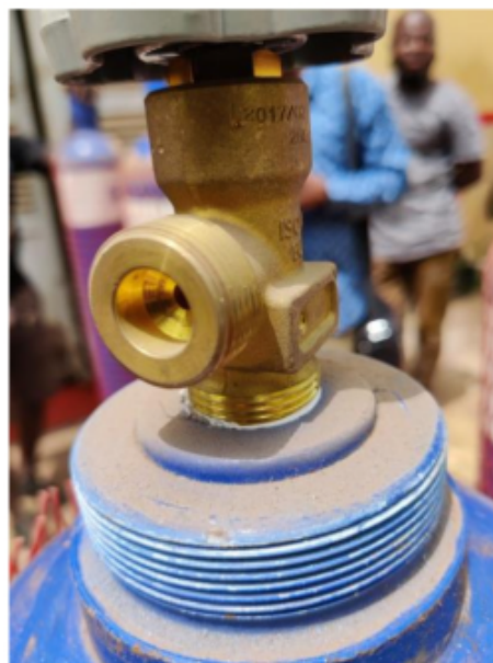
Figures 3 et 4 : Exemples de Vannes de Norme allemandes avec les inscrits d'identification
