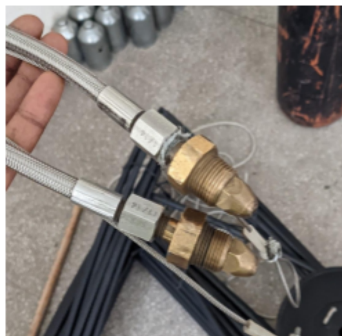
Figure 2: Deux lignes à cylindre Britanniques (BS341 #3) provenant d'un collecteur
