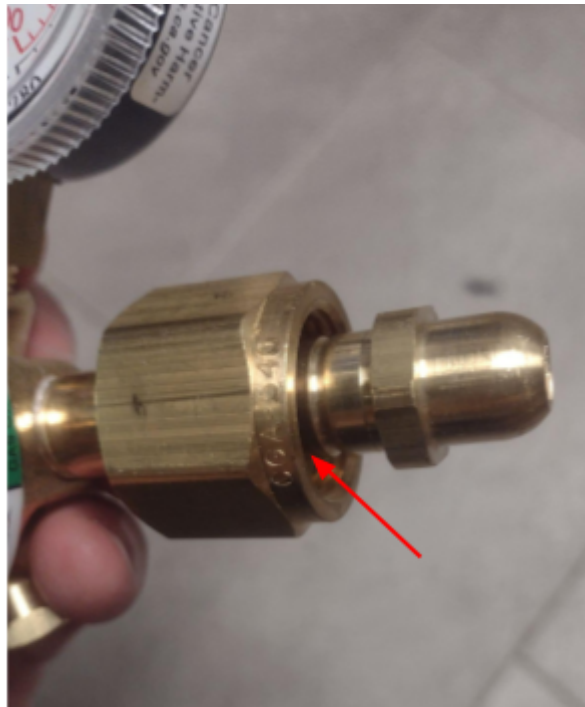
Repare na marca "CGA540" na porca.
