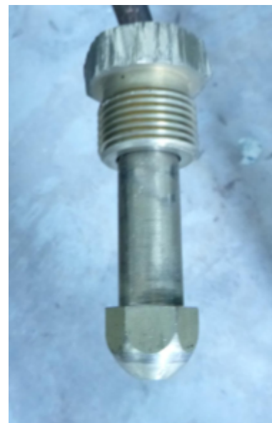
Repare que não existe aro e que o raio é maior do que o do bocal francês.
