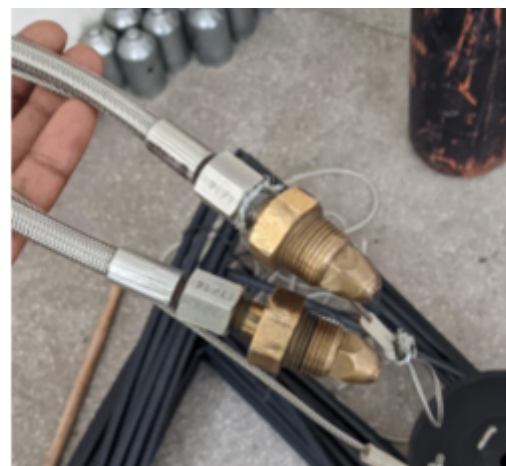
Figura 2: Duas mangueiras de garrafas britânicas (BS341 #3) de um coletor
